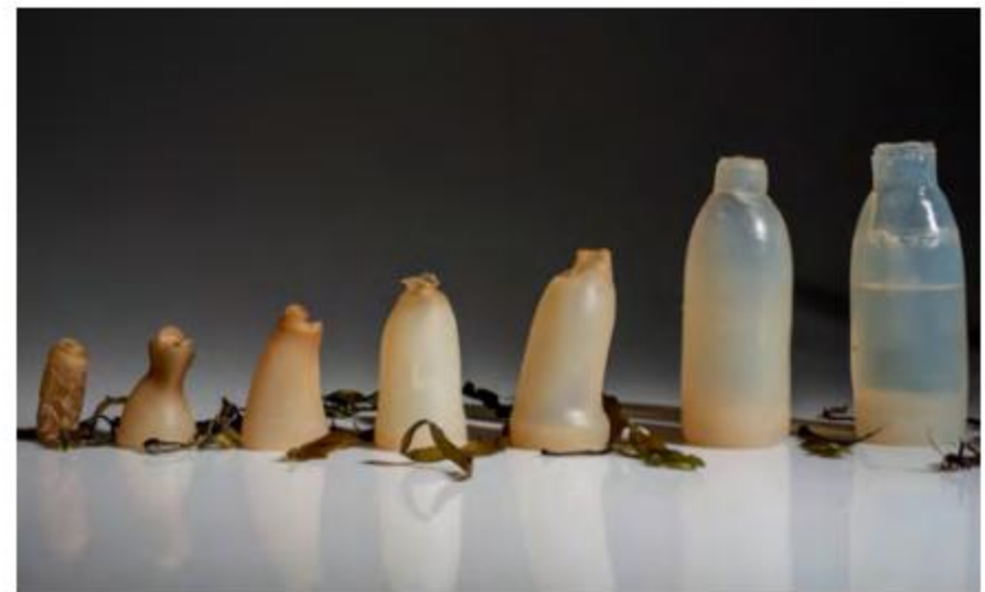
Fig 13. Proceso de degradación de botellas de agua hechas a partir de agar extraído de algas rojas.
