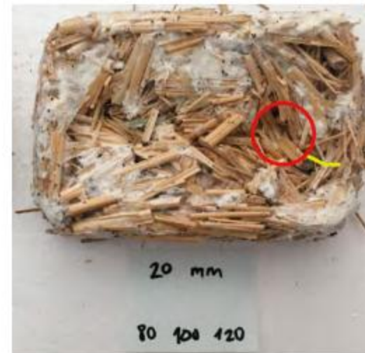
Fig. 53: probetas 10 días, 20 mm, con el respectivo impacto y fracturas
