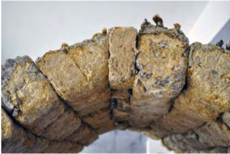
Fig_2: Phil Ross. Detalle estructura micelar realizada a partir de moldes.
