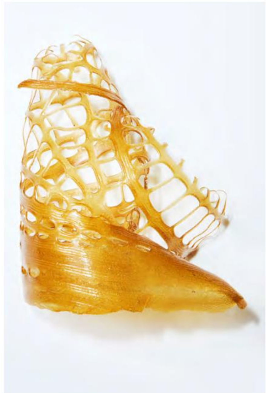
Fig 5. Prototipo impreso con resina de quitosano
