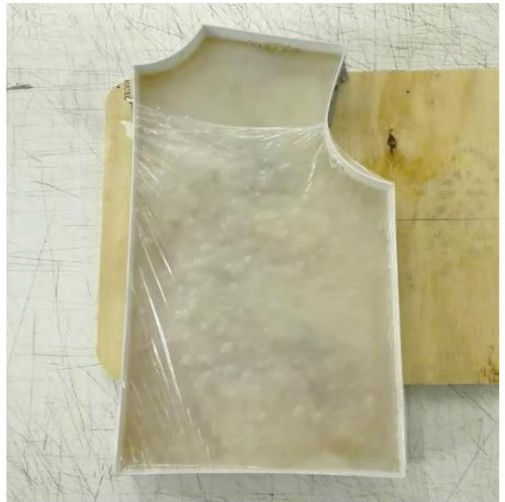
Fig. 38. Segunda semana de cultivo, comenzo a crear el biofilm con exito, generando un espesor adecuado en todo el molde. Se observa que continua tomando la perfecta forma del molde
