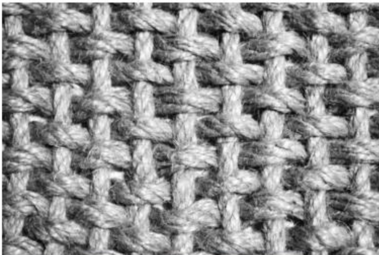
Fig_ 34: Entramado fibra de 10mm de espesor.
