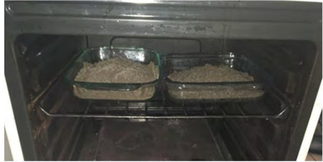
Fig. 9: Esterilización de áridos en el horno.
