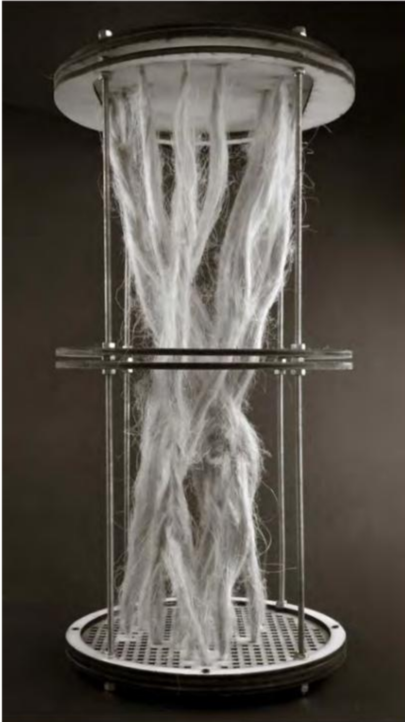
Fig_ 27: Estructura de fibra de cáñamo funcionando a tracción. Día 1 de la inoculación.
