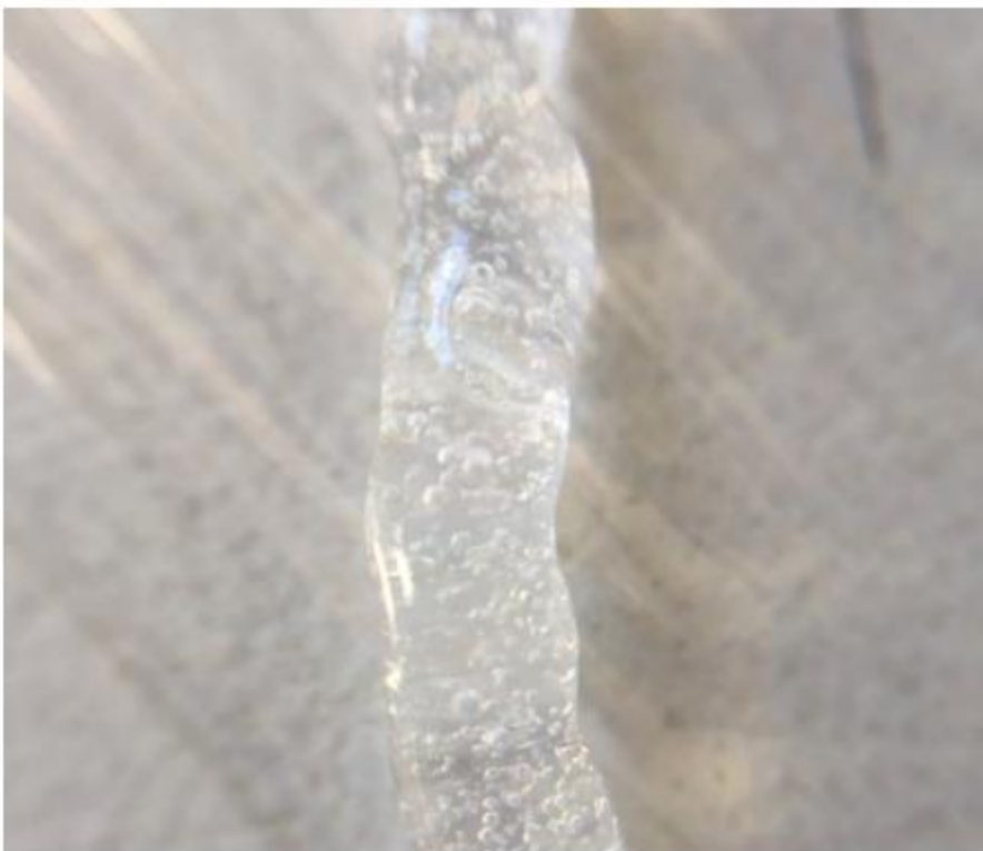
Fig 19. Burbujas en filamentos de la Solución 1.
