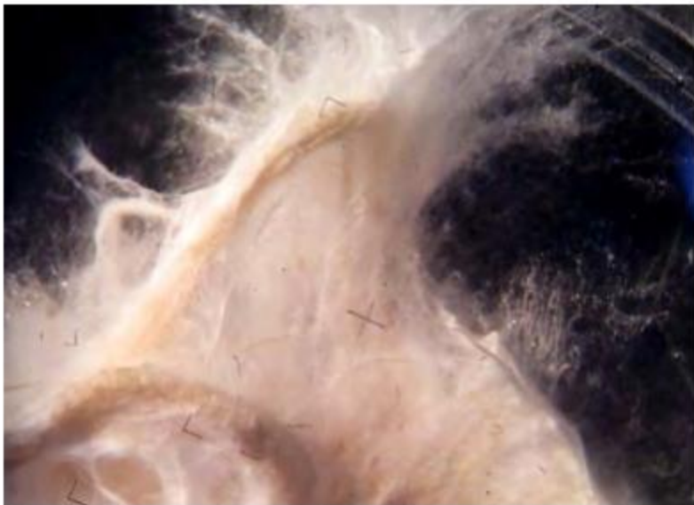
Fig_ 11: Detalle microscópico 8x de crecimiento micelar en fibra de cáñamo.
