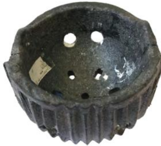
Fig.63: Capa interna de poliestireno expandido de alta densidad
