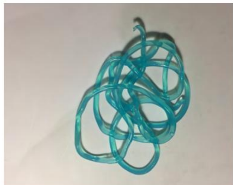
Fig 24 y 25, Filamentos de alginato en solución de cloruro de calcio. Fig 26. Filamento en estado gel. 30/10/17
