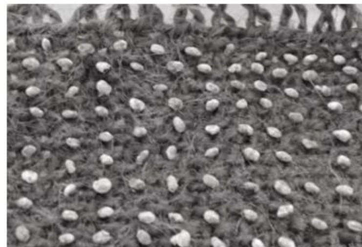
Fig_ 37: Inoculación entramado fibra de 5mm de espesor.
