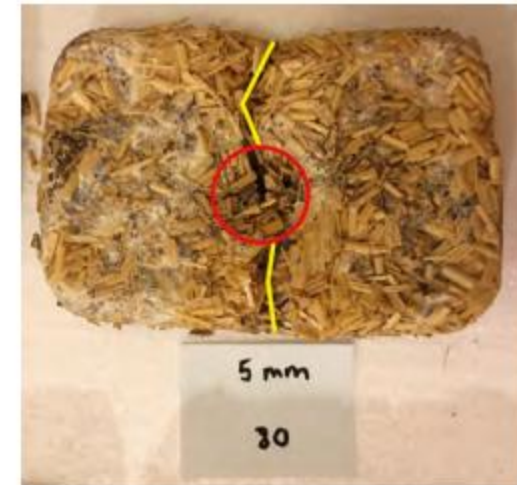
Fig. 47: probeta 7 días, 5 mm, con el respectivo impacto y fracturas
