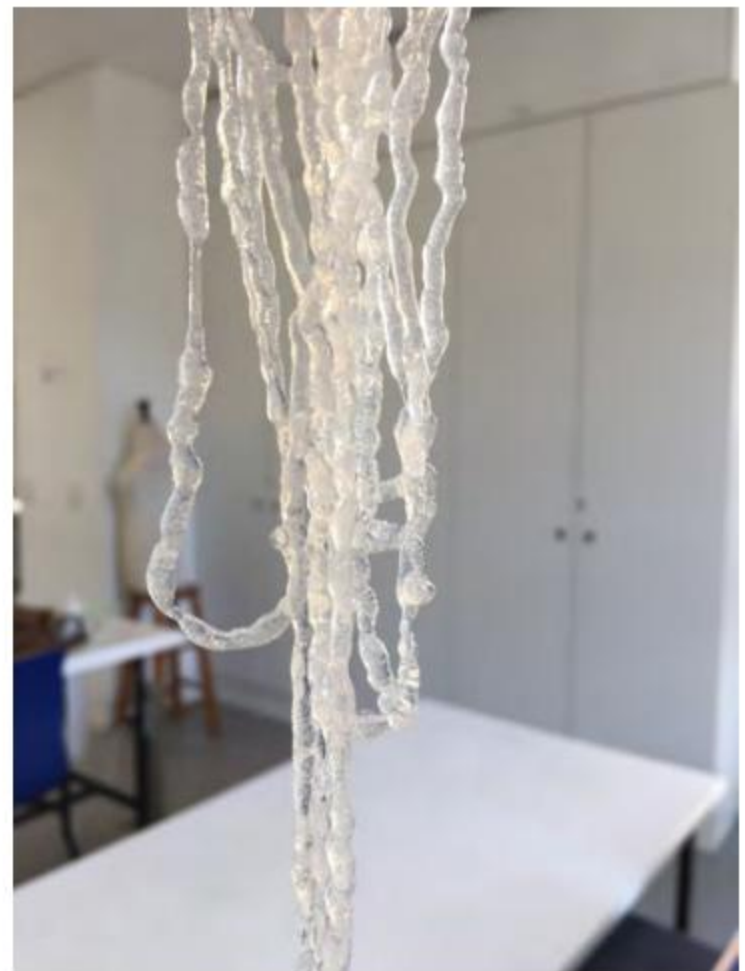
Fig 20 y 21. Filamentos estirados para dejar secar y detalle que muestra la poca constancia del diámetro
