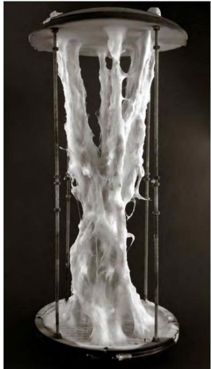
Fig_ 28: Después de 15 día de crecimiento (en la oscuridad, temperatura entre 18 y 20 °C y humedad) la fibra se encuentra colonizada por el micelio. La estructura sigue funcionando a tracción.
