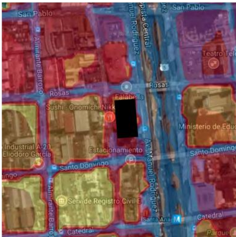
Fig. 5: "mapa de ruido" de la zona aledaña al edificio (en negro), en azul sobre 80dB y rojo sobre 60 dB.
