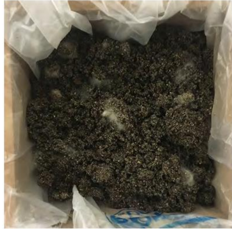
Fig. 16: Probeta A.F. 2, tras dos días de crecimiento del micelio.
