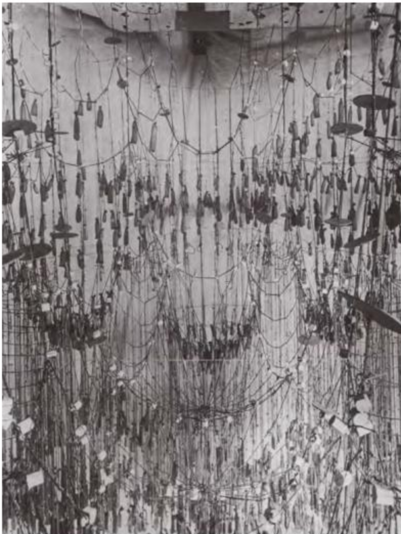
Fig_ 16: Maqueta catenarias de la Sagrada Familia de Gaudí.
