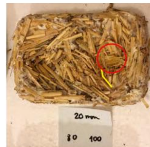
Fig. 48: probeta 7 días, 20 mm, con el respectivo impacto y fracturas
