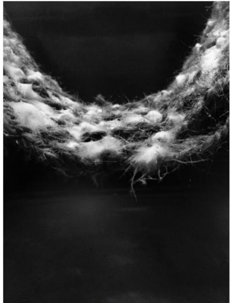
Fig_ 38: Prototipo hecho en base a catenarias de 50cm de longitud. Fotografía sacada una semana después de la inoculación (16/11/17).
