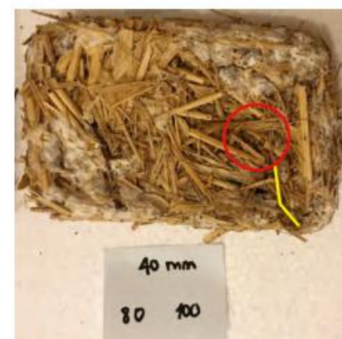
Fig. 49: probeta 7 días, 40 mm, con el respectivo impacto y fracturas
