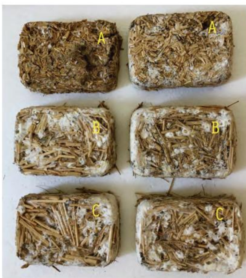
Fig. 50: Probetas 10 días. De arriba hacia abajo, 5 mm, 20 mm y 40 mm
