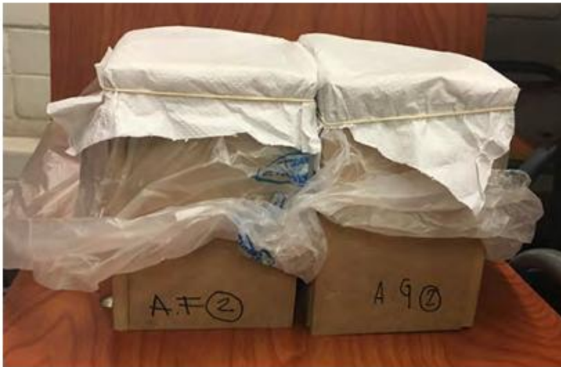
Fig. 15: Probetas A.F. 2 y A.G. 2, en sus moldes de madera de 1 L.
