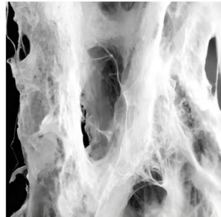
Fig_ 26: Crecimiento micelio en fibra de cáñamo 15 días después de la inoculación.
