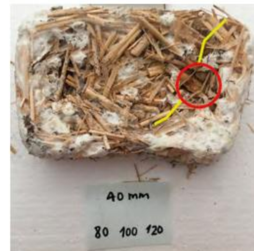
Fig. 54: probetas 10 días, 40 mm, con el respectivo impacto y fracturas
