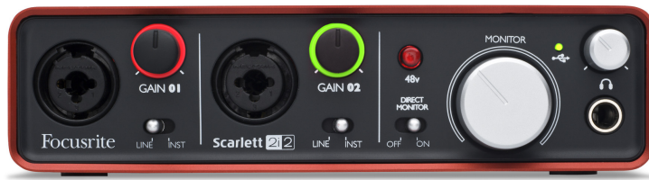
Ejemplos de tarjeta de audio : Focusrite Scarlet 2i2
